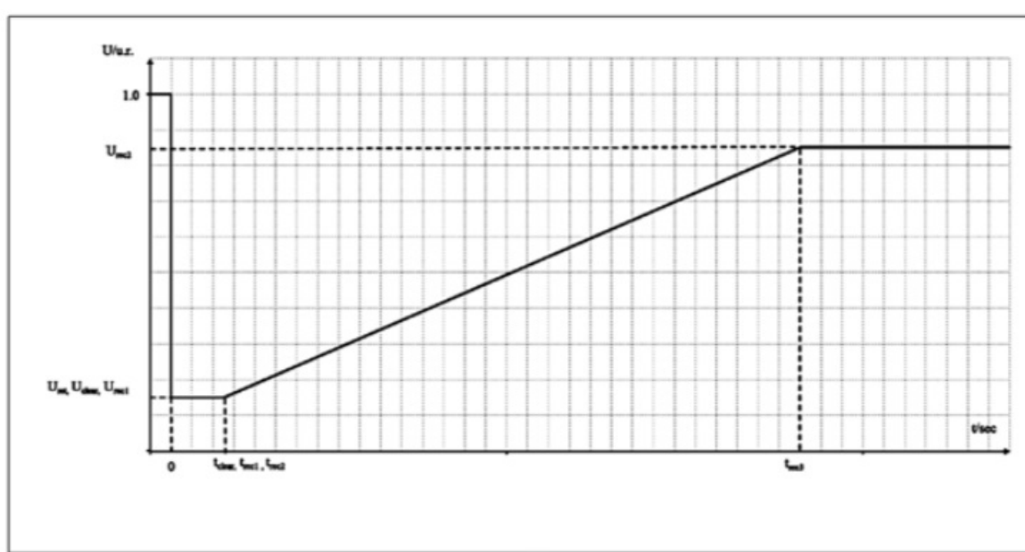
Fig. 3. Diagrama de capacitate privind trecerea peste defect a IS de categorie B și C
